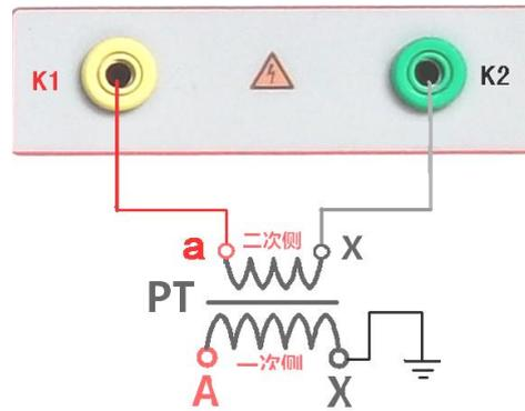
图 19, PT 励磁特性接线图
