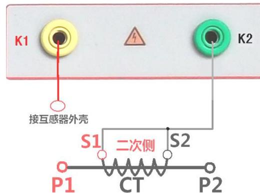
图 17, CT 交流耐压接线图
