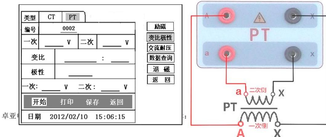
图 21，PT 变比极性测试界面
