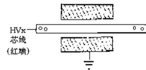
图 11 套管接法
