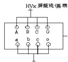
图 12 变压器接法
