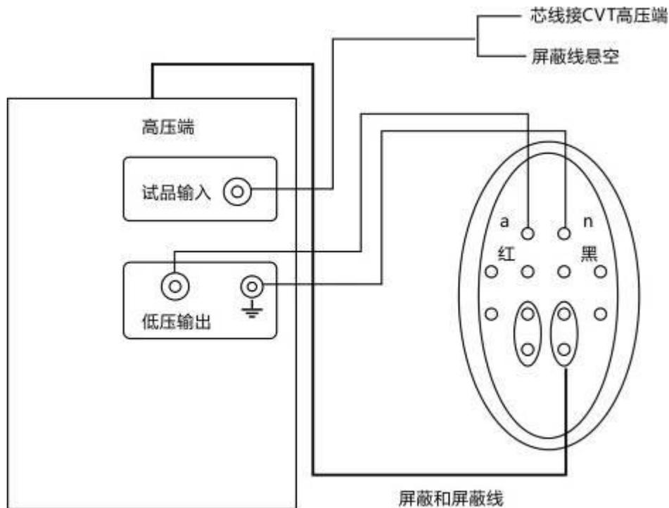
应注意高压线应悬空不能接触地面，否则其对地附加介损会引起误差，可用细电缆连接高压插座与CVT 试品并吊起来，另外考虑C2 或C1 与内Cn 串联分压效应，其电容量可按下式校准：
