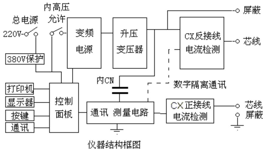
测量电路：傅立叶变换、复数运算等全部计算和量程切换、变频电源控制等。
