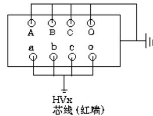
图 14 变压器接法
