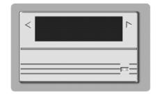
本仪器提供的是 16 行微型面板式打印机,使用寿命长、打印速度快、更换 打印纸和色带容易,无须其他维护和保养。整机电源接通后打印机右下角指示灯 亮,表示打印机处于待机状态,测试中或测试完毕后根据显示提示按下打印键就 可打印出数据。
