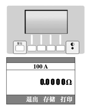
本机的显示器是一个 128×64 点阵液晶显示器,电阻的测量值以及操作信息均通过它显示。显示器分为三个区:上层显示当前测试电流;中间的显示区显示测量的电阻值;最下显示仪器按键功能提示。(因工作状态不同,显示的汉字不同,按键的功能也不同,有关它们的详细信息请参阅后面相关部分)。
