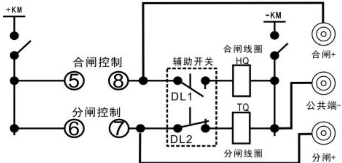
**注意：为保证安全，在输出直流电压时将辅助开关串接在合分闸回路当中**
